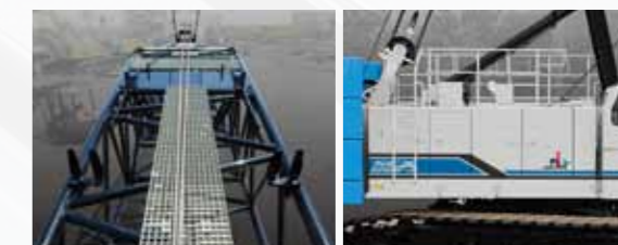
スカイウォーク幅拡大(FRP製) OPTION 折り畳みハウス上部ハンドレール OPTION
